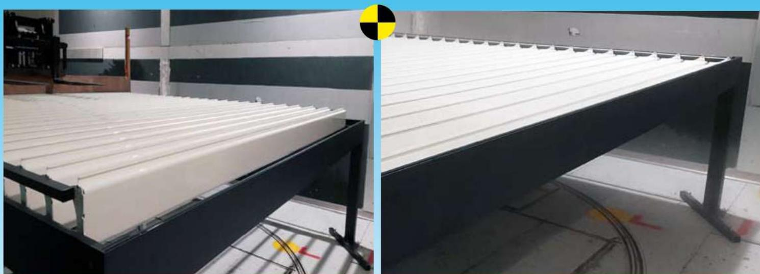
Se ha sometido la pérgola a diferentes incidencias de viento para diferentes **configuraciones de apertura / cierre** de lamas hasta **velocidades elevadas**. Cuando el viento actúa de forma perpendicular a las lamas, éstas pueden sufrir más y los desplazamiento pueden alcanzar niveles elevados. No se ha observado ninguna **fragilidad en las lamas ni en las fijaciones**.
